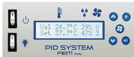
La centralina elettronica con display a cristalli liquidi permette di gestire: temperatura, allarme di massima temperatura, lettura dell'umidità, intensità di ventilazione
